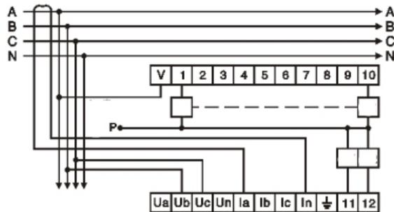
Рисунок 2. Схема подключения контроллера
