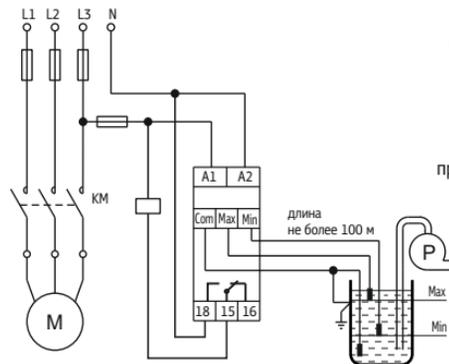
Рисунок 4 - схема подключения реле RL-2ZC
