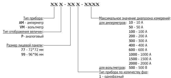
Рисунок 2. Структура условного обозначения приборов
